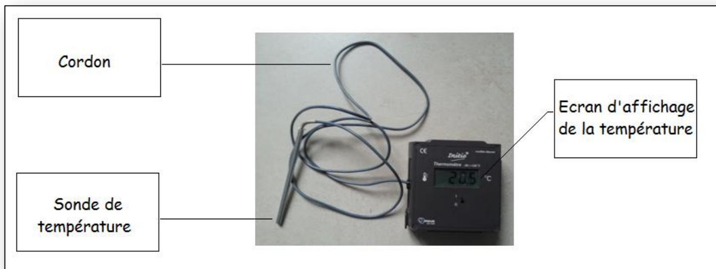
*Pour mesurer la température avec ce thermomètre, il suffit de plonger la sonde dans le milieu dont on veut déterminer la température.*
